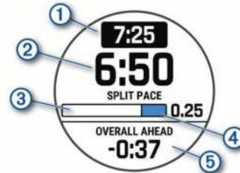
На устройстве отображается целевой темп на отрезке ①, текущий темп на отрезке ②, ход выполнения отрезка ③, расстояние до конца отрезка ④ и общее время опережения или отставания от целевого темпа ⑤.
